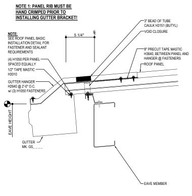
ON-SLOPE GUTTER DETAIL
